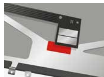
柔性线路板 (FPC) 粘贴
