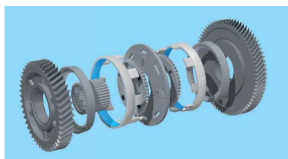
将摩擦材料如碳纤维粘合到同步环上
